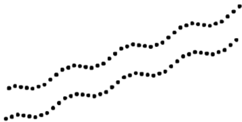
la roue d'échappement ne tourne pas rond
