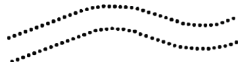
variation de la marche du balancier, mauvaise transmission ou perte d'amplitude.
