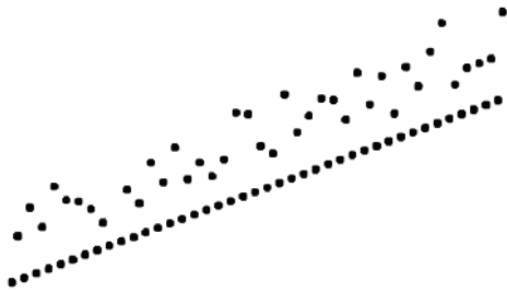
échappement endommagé ou palet endommagé
